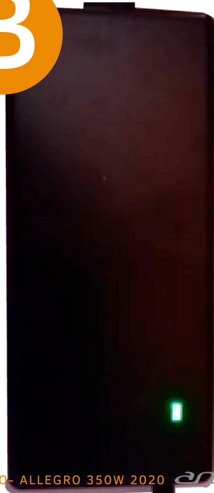
La batería tarda 4 a 5 horas en cargarse completamente, cuando se utiliza con el cargador que se suministra con tu bicicleta.
