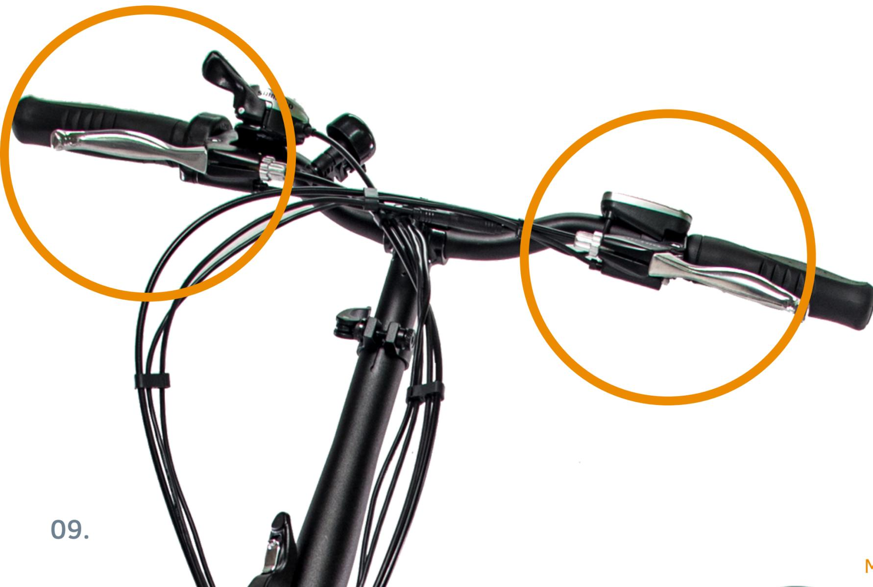
Cuando presionas los frenos, el controlador va hacer que la bicicleta detenga inmediatamente la asistencia del motor.
