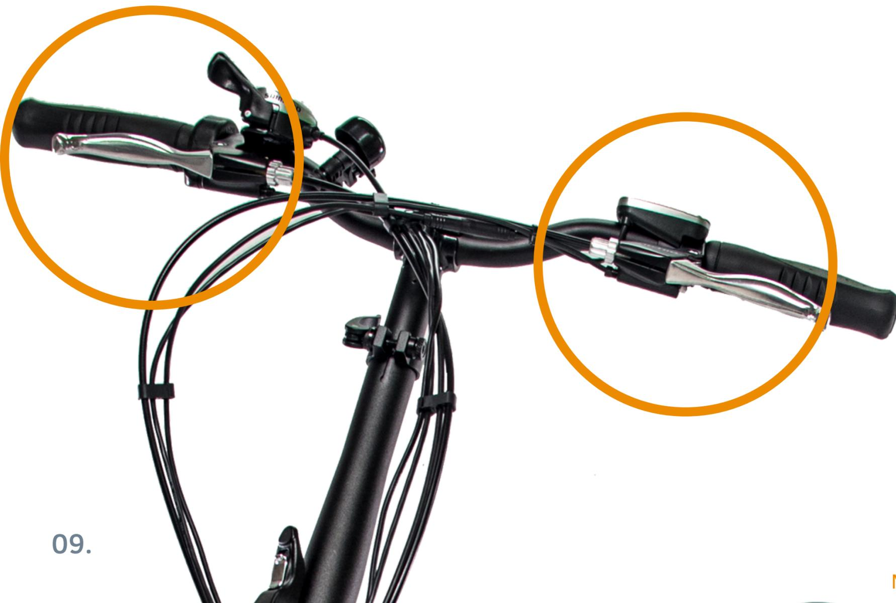
Cuando presionas los frenos, no solo se detendrá la llanta, el controlador va hacer que la bicicleta detenga inmediatamente la asistencia del motor.
