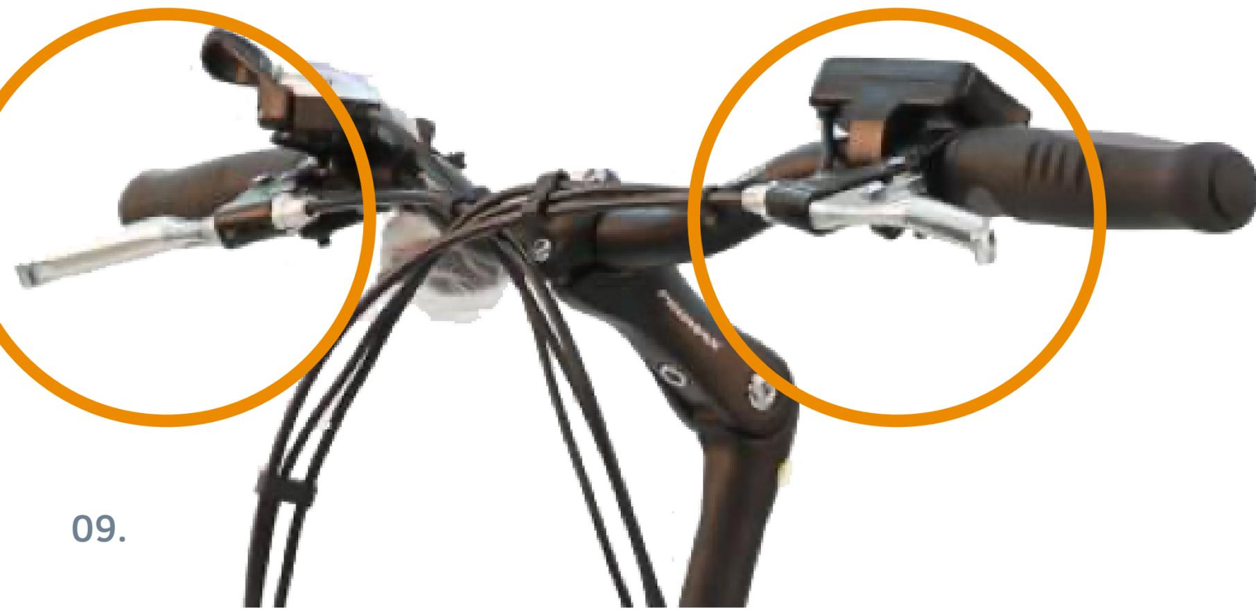
Cuando presionas los frenos, no solo se detendrá la llanta, el controlador va hacer que la bicicleta detenga inmediatamente la asistencia del motor.
