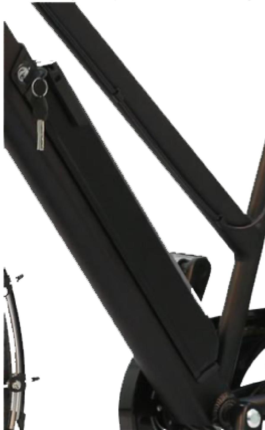
Para quitar la batería, gira la llave a \*unlock\*, tira de la palanca ubicada en el costado de la batería al lado de la llave, al tirar de la palanca la batería saldrá.
